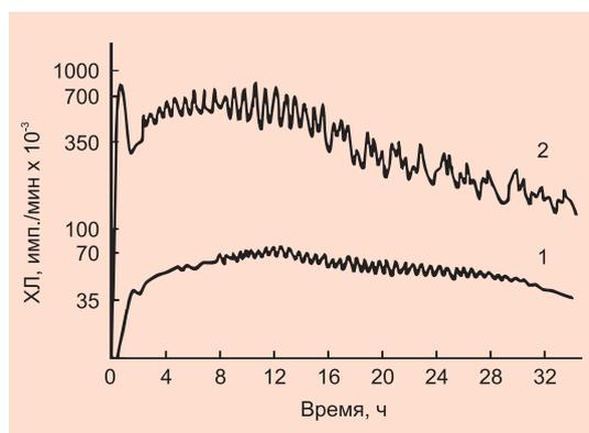
Рис. 3.1. Нелинейная кинетика развития хемилюминесценции (ХЛ) в различных реакционных системах: 1 – (глюкоза–глицин (60 мМ, 60 мМ; 20 мл; рН 11,0); 2 – метилгликоксаль–глицин (10 мМ, 30 мМ; 20 мл; рН 10,6), как пример осцилляторной регуляции
