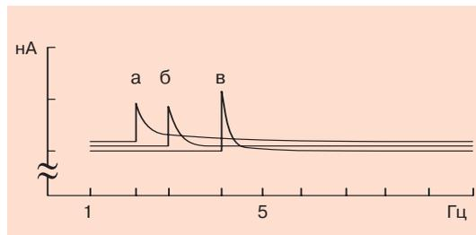
Рис. 3.10 Поток ионов в растворе глутаминовой кислоты как функция частоты переменного магнитного поля для различных значений постоянного магнитного поля. По оси  $x$  – частота переменного магнитного поля (Гц), по оси  $y$  – поток ионов (нА). Амплитуда переменного магнитного поля равна 0,025 мкТ; постоянное магнитное поле а:  $V_0 = 20$  мкТ; б:  $V_0 = 30$  мкТ; в:  $V_0 = 40$  мкТ
