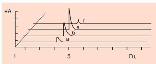
Рис. 3.11. Поток ионов в растворе глутаминовой кислоты как функция частоты переменного магнитного поля для различных значений амплитуды переменного магнитного поля (Гц), по оси y — поток ионов (нА). Постоянное магнитное поле  $V_0 = 40$  мкТ; амплитуда переменного магнитного поля а:  $V = 0,01$  мкТ; б:  $V_0 = 0,02$  мкТ; в:  $V_0 = 0,04$  мкТ; г:  $V_0 = 0,08$  мкТ
