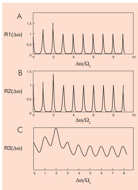
Рис. 3.4. Частотные окна в изменениях тепловой энергии в ионах внутри макромолекулы при комбинированном воздействии постоянных и переменных магнитных полей. По оси ординат: резонансные пики тепловой энергии движения иона, нормализованные на первоначальную энергию без воздействия переменных магнитных полей в относительных единицах. По оси абсцисс: безразмерный частотный сдвиг  $\Delta\omega/\Omega_L$ .
