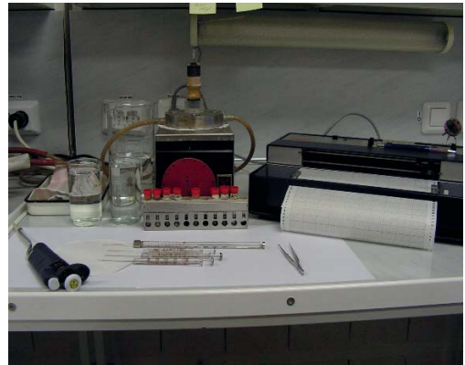
Рис. 1. Полярографическая измерительная установка состоит из электрода Кларка, ячейки с перемешивающим стержнем, термостатируемого кожуха, водяного термостата I ТЖ-0 03 (Россия), магнитной мешалки ММ-3М (Россия), самописца LKB Bromma 2210 2-Channel Recorder (Швеция).
