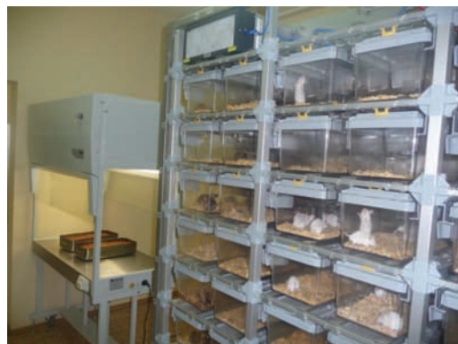
Рис. 1. Изоляторная вентилируемая система «RAIR»
